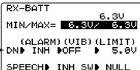
DN (ダウン)とはセットした電圧より下がったときにアラームが起動することを示します。
