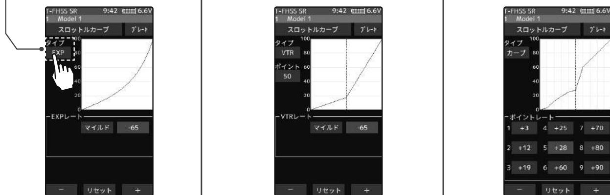
スロットルのニュートラルからハイポイントまでを、曲線カーブで動作させるカーブタイプ。
