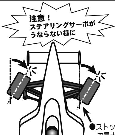
ステアリングサーボは、車体側の最大舵角で、サーボに無理な力が加わらないように調整する。
