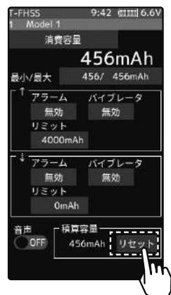
送信機側でのリセット操作は、T7PXR の積算容量表示をリセットする機能で、SBS-01C 本体の積算値をリセットするものではありません。SBS-01C の消費容量測定範囲は最大 32767mAh です。これを超えた場合、送信機の消費容量表示も自動的にリセットされます。タイミングによっては計測中にリセットされてしまう場合がありますので、積算容量の表示が 32767mAh になる前に、SBS-01C 側の積算をリセットしてください。
