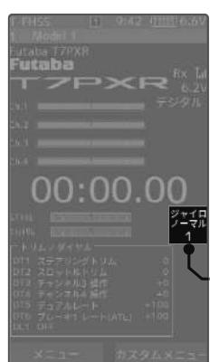
ホーム画面にジャイロの現在の動作モード(ノーマル/AVCS)と、選択されているジャイロデータインジケータを表示します。
