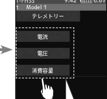
複数のデータから、表示するデータを選ぶ、例えば電流センサーの場合、電流 / 電圧 / 消費容量から選ぶことができる。
