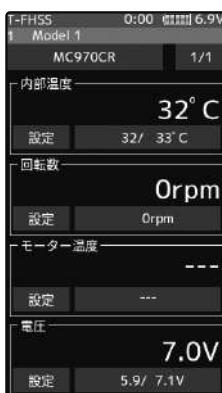
MC970CR がテレメトリーセンサーとして登録されると、他の温度センサーや回転センサー等と同じようにリミット、アラーム、バイブの設定が可能です（P178 参照）。
