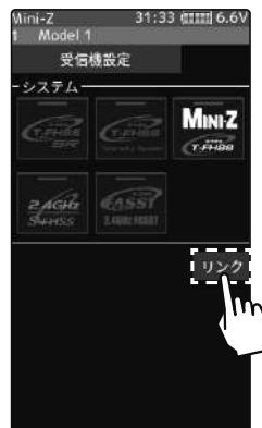
**3** MINI-Z 受信機 RA-42 のリンクスイッチを 2 秒以上押した後、放します。
