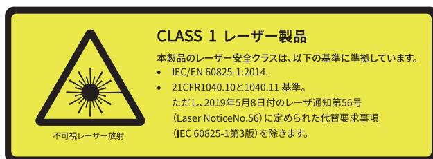
S1 はマルチビーム LiDAR を搭載しており、下記の安全基準に適合しています。
