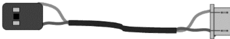
航空ユニットの S-BUS ケーブルの接続 - 箱 6
