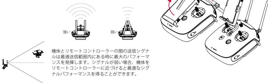
機体とリモートコントローラーとの間の送信シグナルは最適送信範囲内にある時に最大のパフォーマンスを発揮します。シグナルが弱い場合、機体をリモートコントローラーに近づけると最適なシグナルパフォーマンスを得ることができます。
