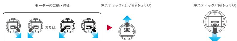
機体を降下させる為に、機体が地面に接するまでゆっくりと左（スロットル）スティックを引いてください。モーターを停止させるために、両方のコントロールスティックを斜め下の内側または外側に引いてください。
